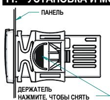
Контроллер XR75CX должен монтироваться на вертикальной панели в вырез 29x71мм и закрепляться, используя поставляемые специальные держатели.
